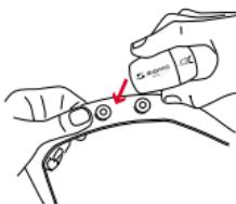
Закрепите передатчик R3 на кнопках нагрудного ремня. **Важно:** для экономии заряда батареи после тренировки отсоедините передатчик R3 от ремня. Передатчик всегда активен, если между двумя контактами может проходить ток. Это возможно в том случае, если нагрудный ремень надет на кожу, или нагрудный ремень и/или передатчик R3 лежат на влажном полотенце. Если светодиодный индикатор мигает, передатчик R3 включен.
