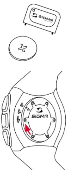
V bežeckom počítači s používa batéria CR2032 (výr. č. 00342) a v snímači R3 batéria CR2450 (výr. č. 20316).
