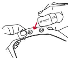
Oddajnik R3 pripnite na pritiskalna gumba prsnega pasu.
