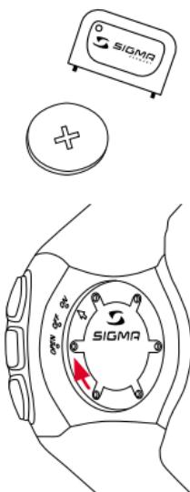
В беговом компьютере используется батарея CR2032 (арт. № 00342), а в датчике R3 — батарея CR2450 (арт. № 20316).
